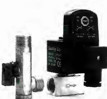
Электронный конденсатоотводчик Xeleron XTD-01 с электронным таймером и соленоидным клапаном для обеспечения автоматического сброса конденсата из систем сжатого воздуха. Пропускная способность клапана составляет до 600 л/час. Присоединение вход и выход – резьба G 1/2". Максимальное рабочее давление 16 бар.
